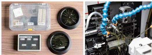
コンタクトプローブは、CNC精密自動旋盤で製造した非常に微細な部品を組み合わせて完成する
