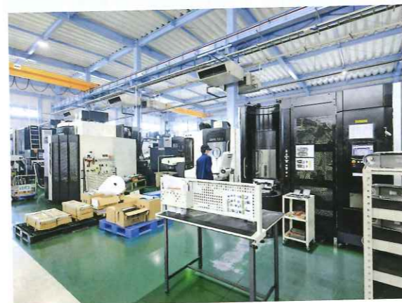
5軸MCにロボットを使ったパレットチェンジャーを加え生産性向上を図る(秋谷鉄工所)
